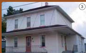
3 • Maison de style cubique datant de 1917, comportant une toiture à quatre versants, dite à « quatre-eaux ». Cette dernière arbore un revêtement en bardeau de cèdre comportant des motifs.
